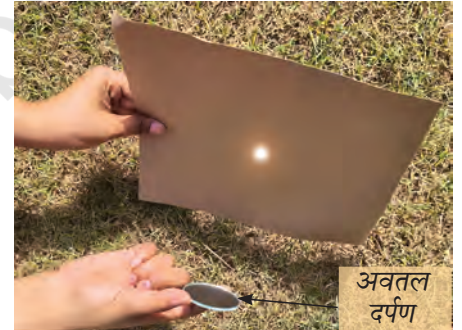
चित्र 10.12 — अवतल दर्पण द्वारा सूर्य के प्रकाश को कागज पर अभिसरित करना
