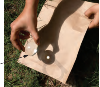
चित्र 10.19— उत्तल लेंस का उपयोग करके कागज पर सूर्य के प्रकाश को अभिसरित करना।
